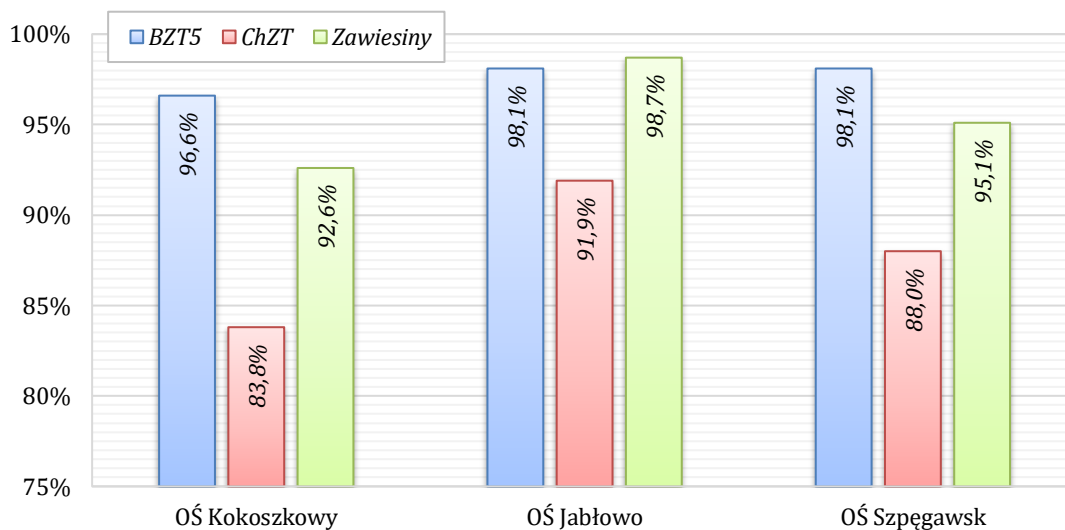
Wykres 14. Stopień redukcji zanieczyszczeń w komunalnych oczyszczalniach ścieków funkcjonujących na terenie Gminy Starogard Gdański (2020 r.)
